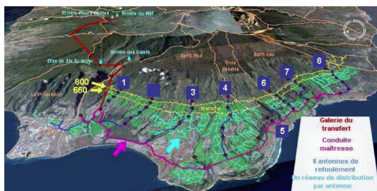
Figure 4 : Synoptique du système hydraulique d'ILO (source : Département de la Réunion)
